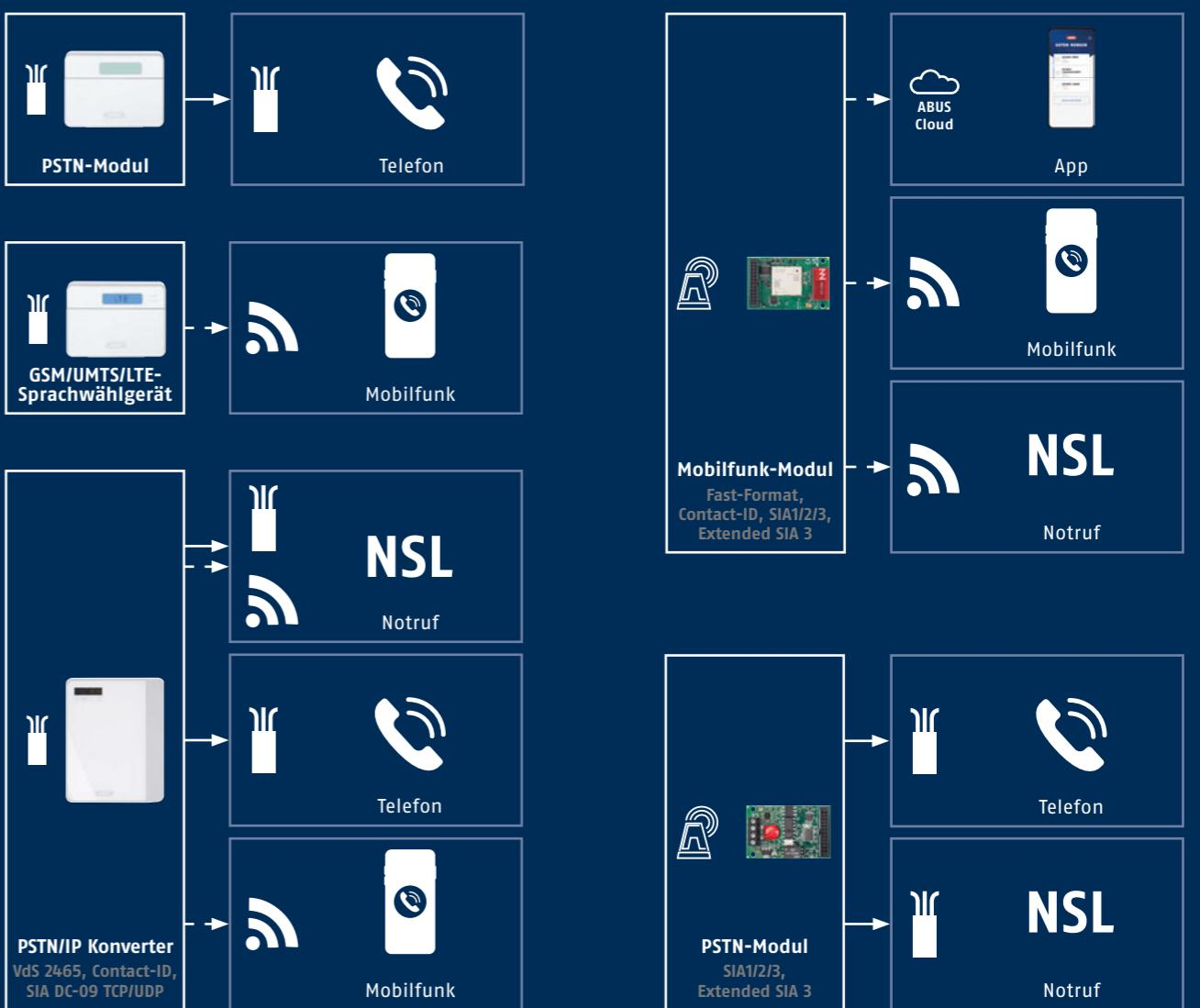
Nicht zum Heulen: Ist im Objekt der Externalarm mit lauter Außensirene nicht erwünscht oder ausreichend, erfolgt der Fernalarm an gespeicherte Telefonnummern oder Notruf- und Service-Leitstellen (NSL). Bei Bedarf (z. B. Netzwerkausfall) auch über Mobilfunk.
