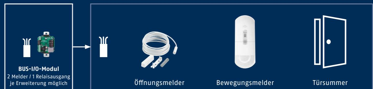
Mit dem Mini-Modul lassen sich Drahtmelder frei im Gebäude platzieren und einfach am System-BUS anrahen. Das Modul mit integriertem Relaisausgang passt in eine Schalterdose (55 mm), die neben den Meldern gesetzt wird. Dies spart Kabelstrecke und Arbeitszeit bei der Installation.
