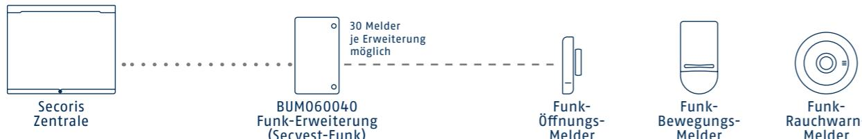
Die Secoris BUS-Funkerweiterung BUM060040 schafft die Brücke zu den Funkmeldern, mechatronischen Sicherungen und weiteren Funkkomponenten der Secvest. Zum Upgrade einer Bestandsanlage von Secvest auf Secoris wird nur die Zentrale getauscht und die Funkerweiterung installiert. Bisherige Funkkomponenten arbeiten einfach mit der Secoris weiter.
