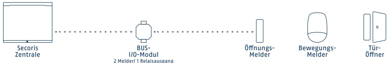
Mit dem Mini-Modul lassen sich Drahtmelder frei im Gebäude platzieren und einfach am System-BUS anrahen. Das Modul mit integriertem Relaisausgang passt in eine Schalterdose (55 mm), die neben den Meldern gesetzt wird. Dies spart Kabelstrecke und Arbeitszeit bei der Installation.
