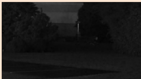
Nachtaufnahme ohne Thermal-Technologie (optische Kamera): kein Eindringling zu erkennen, keine Objekterkennung, kein Bewegungsalarm
